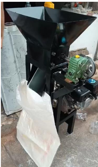
Gambar 6. Mesin pencacah botol plastik yang telah selesai dibuat
